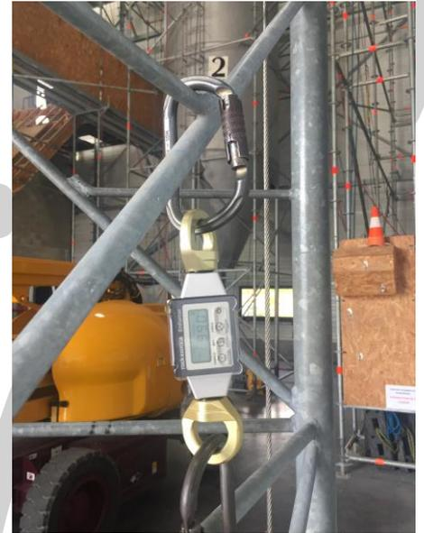
Les tests réels ont permis de valider **les supports d'amarrages garantis** des pylônes du plateau technique de Positiv' Formation. Ils ont été matérialisés au moyen d'un code couleur rouge
