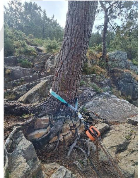
**Dispositif d'ancrage et ancre structurelle non garantis nécessitant un principe de redondance pour les travaux d'accès et de positionnement aux moyens de cordes.**
