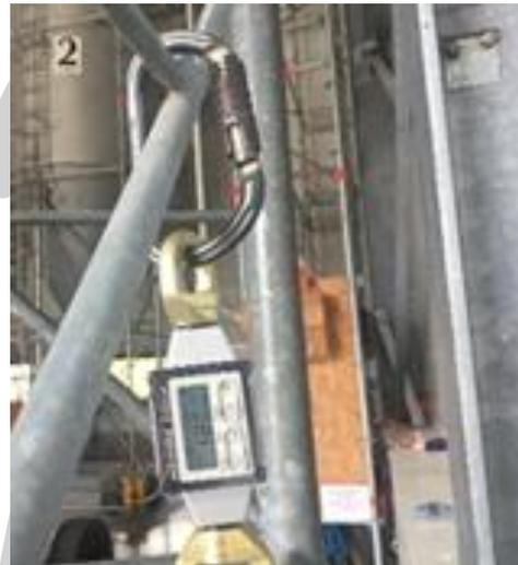
Les tests réels ont permis de valider **les supports d'amarrages garantis** des pylônes du plateau technique de Positiv Formation. Ils ont été matérialisés au moyen d'un code couleur rouge
